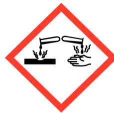
SGH05 Produits corrosifs
