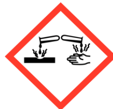
SGH05 Produits corrosifs
